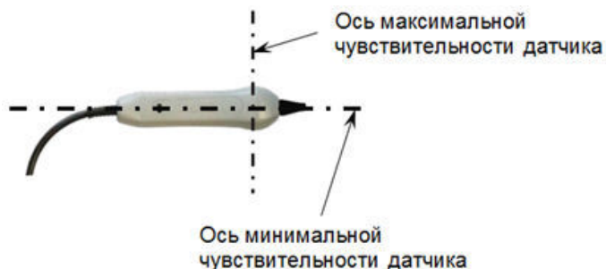
Рисунок А.2. Оси чувствительности датчика ЭМД-127.
